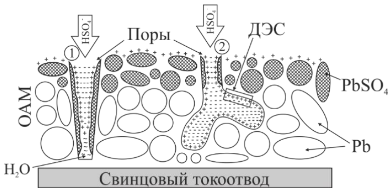
Рисунок 10 – Схематическая иллюстрация электроосмоса при разряде СК АБ
