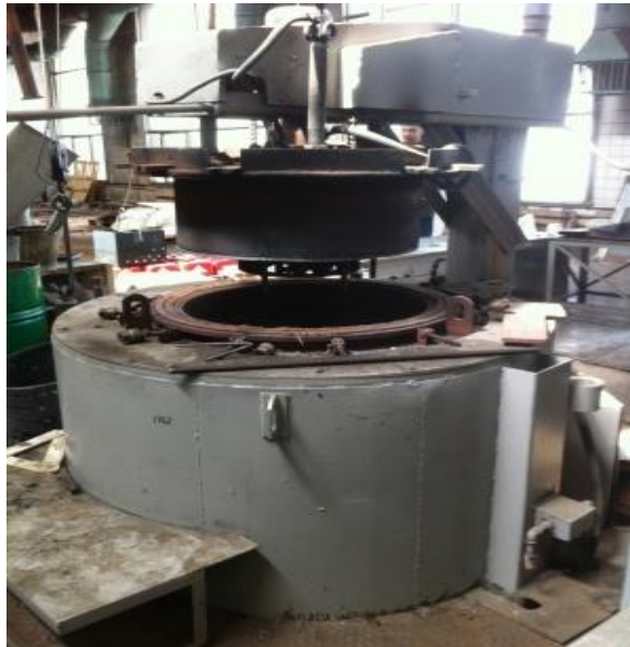
Рисунок 2.3 – Шахтная печь СШЦМ (процесс выгрузки нитроцементованных изделий)
