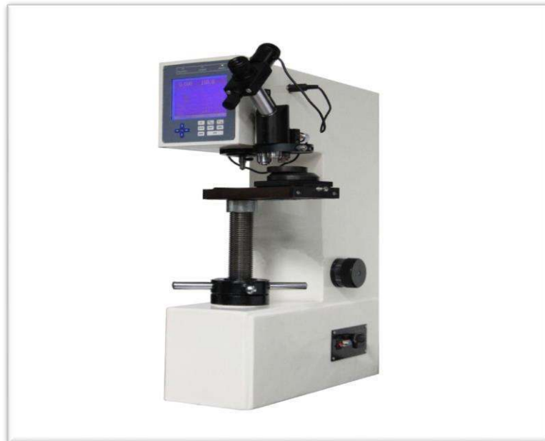
Рисунок 2.9 – Универсальный твердомер ИТБРВ-187,5-М для измерения твёрдости по Роквеллу, по Бринеллю и по Виккерсу
