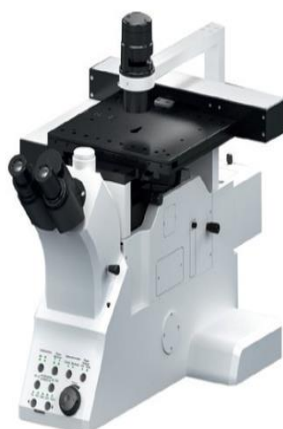
Рисунок 2.6 – Металлографический микроскоп, использованный для исследования микроструктуры нитроцементованных сталей
