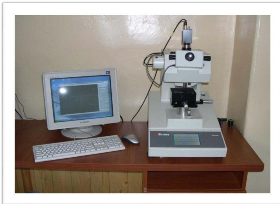
Рисунок 2.10 – Микротвердомер Duramin-5 с цифровой регистрацией результатов (общий вид)
