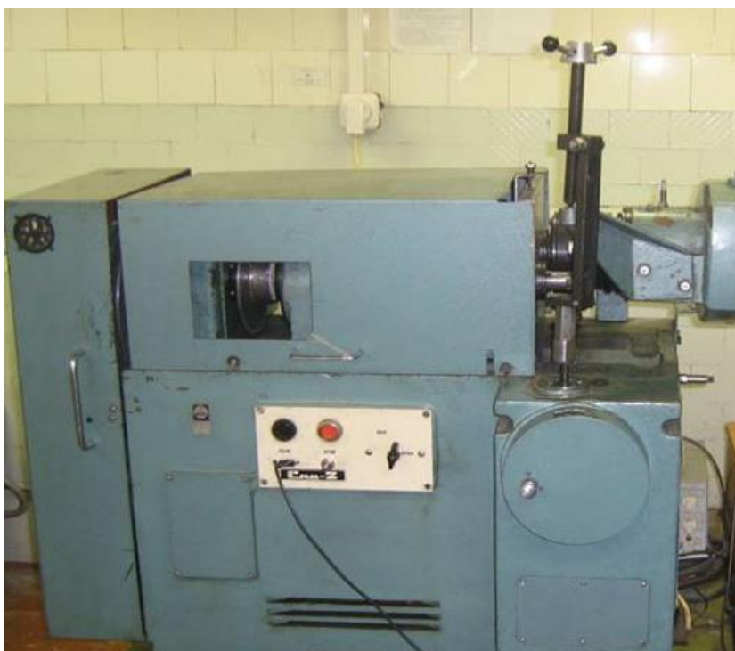
Рисунок 2.11 – Машина трения СМЦ-2 для исследования износостойкости нитроцементованных штамповых сталей
