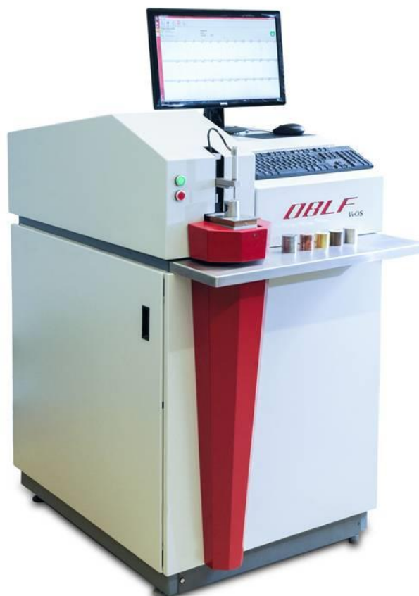
Рисунок 2.1 – Оптико-эмиссионный спектрометр с цифровой регистрацией
