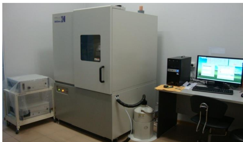
Рисунок 2.8 – Общий вид рентгеновского дифрактометра XRD – 7000S, использованного для рентгеноструктурного анализа нитроцементованных штамповых сталей
