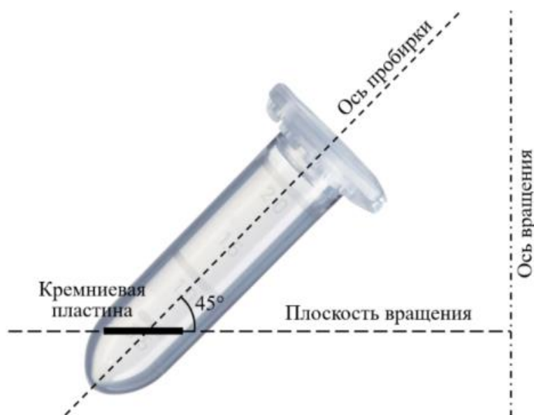
Рисунок 3.2 – Расположение подложки в центрифуге
