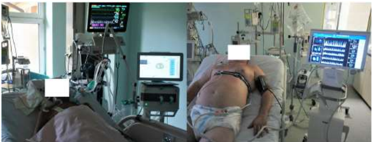
Рисунок 1.3 - Примеры электроимпедансных томографов: справа: мобильный PulmoVista, Dreager, Германия; слева: электроимпедансный томограф, интегрированный с Elisa 800 VIT, Leowenstein Medical, Германия [119]
