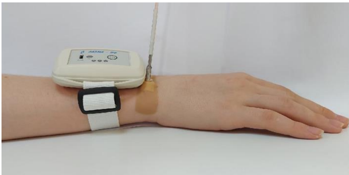
Рисунок 2.14 – Расположение портативного анализатора ЛДФ (слева) и оптического зонда стационарного устройства ЛДФ (справа) на руке испытуемого при проведении исследования
