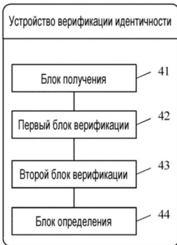
Рисунок 1.2 – Пример устройства осуществления верификации идентичности выполненного на модульной основе
