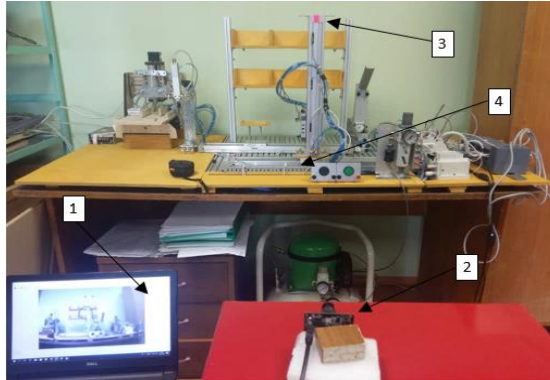
Рисунок 15. Экспериментальная установка интеллектуального мехатронного комплекса с ВННСТЗ: 1 – компьютер (программа для ЭВМ № 2020667278); 2 – камера Ріху СМУcam5; 3 – цветочная метка; 4 – бесштоковый цилиндр
