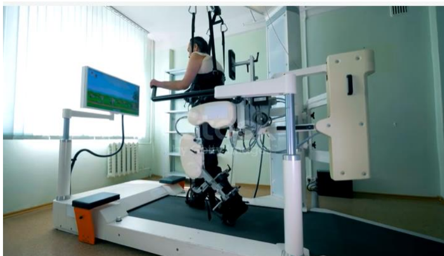
Рисунок 4.8 - Пример прохождения сеанса реабилитации в биотехнической системе с виртуальной реальностью пациентом с нарушением двигательных функций нижних конечностей
