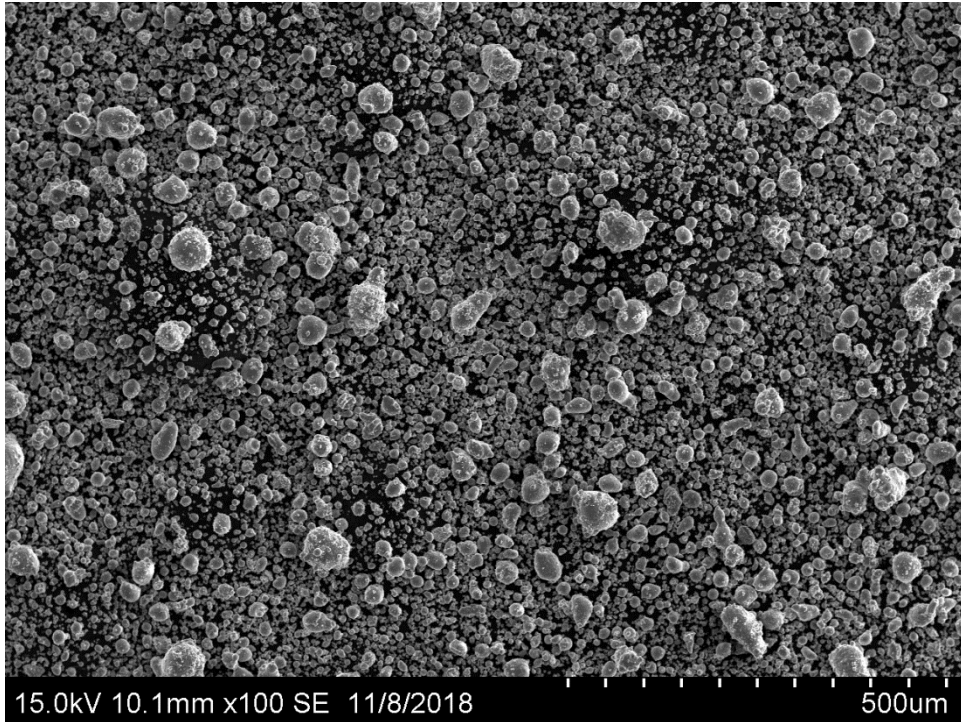
Рисунок 2 - Шихта алюмокомпозита системы Al-4мас.%Mg с \text{Si}_3\text{N}_4 .
