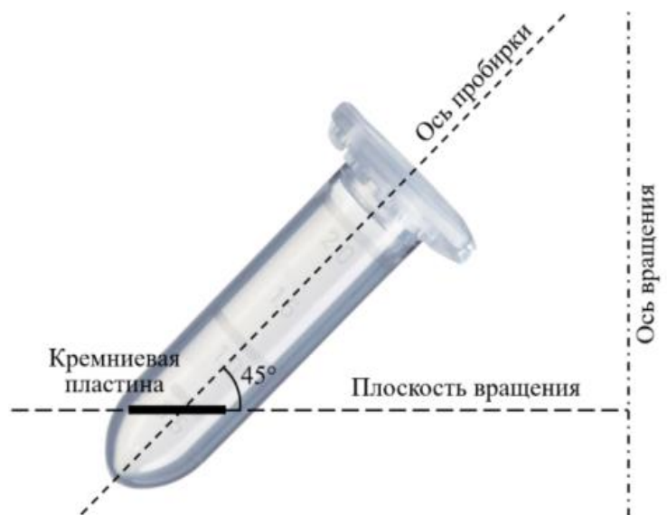
Рисунок 1 – Расположение подложки в микропробирке
