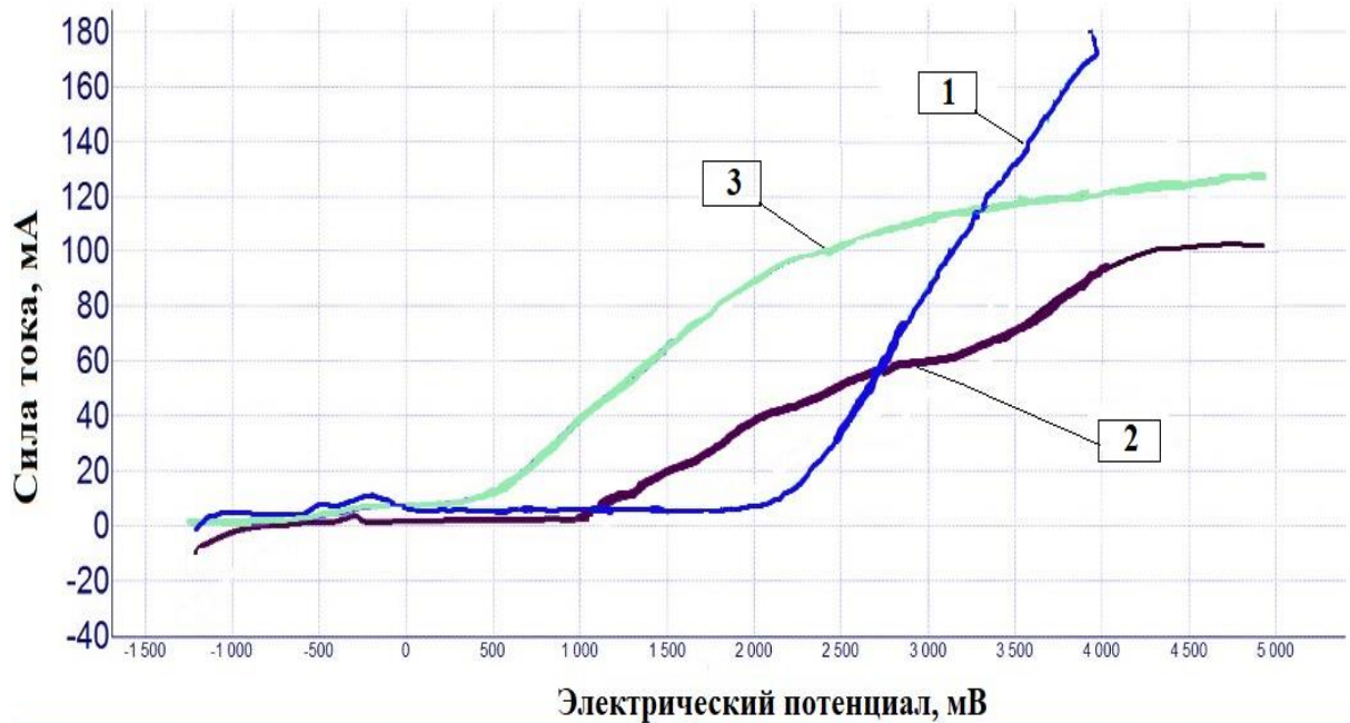
Рисунок 5.14 – Исследование поляризационных кривых и точек начала роста потенциала МДС из МДМ, полученных: 1 – в воде; 2 – в керосине; 3 – промышленный сплав ССуЗ
