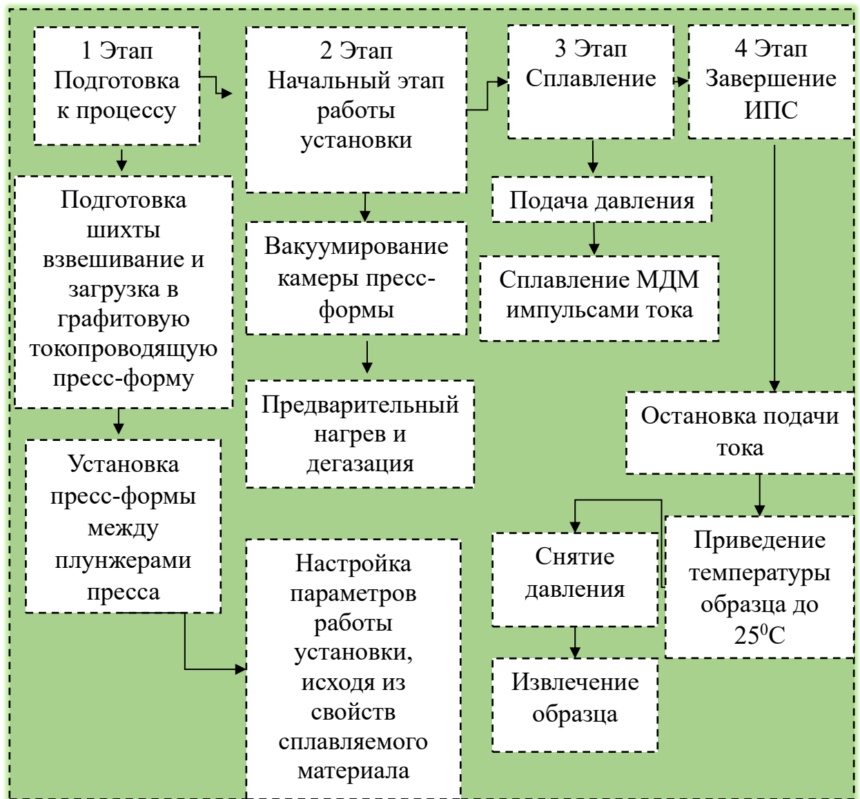
Рисунок 3.15 – Схема получения новых свинцово-сурьмянистых сплавов из мелкодисперсных материалов методом ИПС
