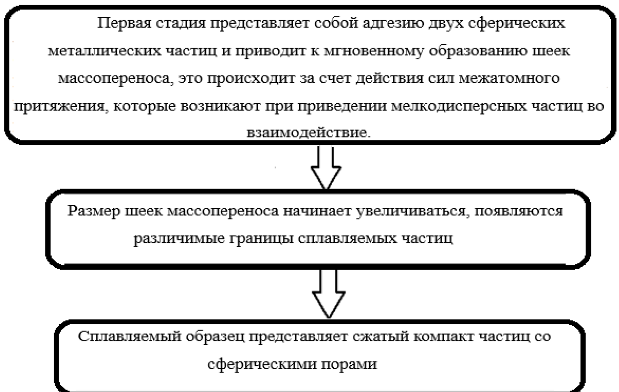
Рисунок 2.9 – Стадии сплавления порошковых материалов
