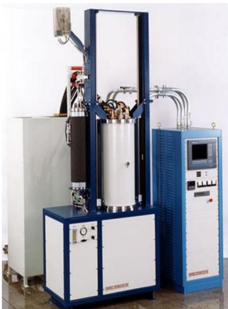
Рисунок 3.16 – Внешний вид оборудования для искрового плазменного сплавления мелкодисперсных материалов «SPS 25-10 Thermal Technology»
