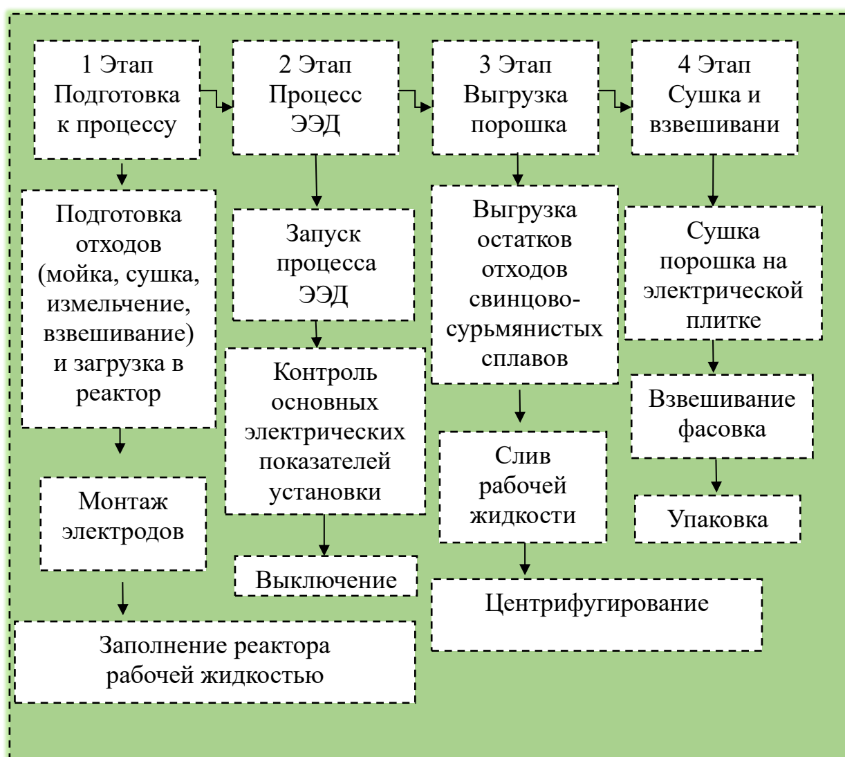
Рисунок 3.2 – Схема получения мелкодисперсных материалов методом электроэрозионного диспергирования
