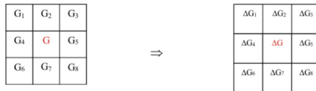
Рисунок 5. Разность градиентов относительно центральной ячейки
