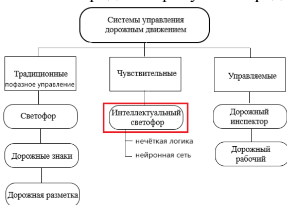
Рисунок 1. Классификация систем управления дорожным движением
