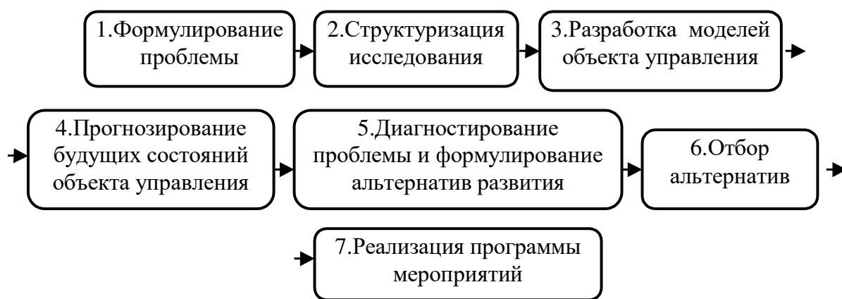
Рисунок 1 - Последовательность этапов системного анализа сложной проблемы
