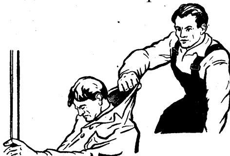
Рисунок 2.3 – Освобождение пострадавшего от действия тока в установках до 1000 В оттаскиванием за сухую одежду
