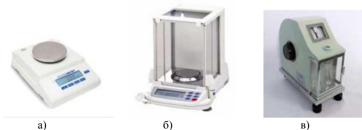
Рисунок 1 - Весы, используемые в лабораторном анализе (а) технохимические; б) аналитические; в) торсионные)
