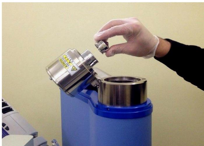
**Рис. 15. Установка катода в катодный узел**
