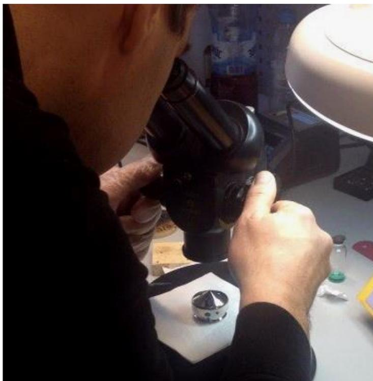
**Рис. 13. Визуальный контроль качества очистки электрода Венельта**
