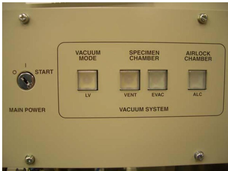
Рис. 9 Панель включения JEM-6610LV
