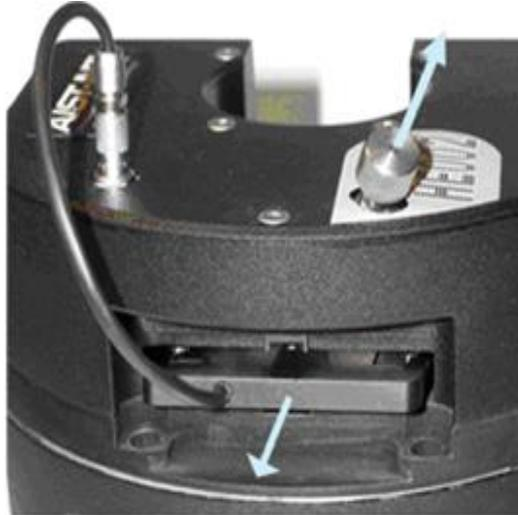
Рис. 9 Извлечение каретки зонда из измерительной головки СЗМ.
