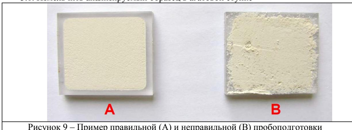
3.2. Насыпать порошок в кювету выше краев, излишки срезать при помощи покровного стекла, при этом важно не уплотнять порошок, т.к. это может вызвать преимущественную ориентацию кристаллов (текстурирование). На рисунке 9 показаны правильно (А) и неправильно (В) подготовленные пробы
