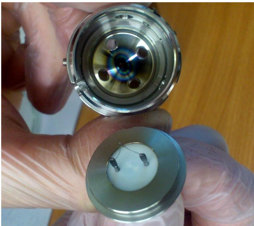
**Рис. 11. Катод и корпуса электрода Венельта в разборе**
