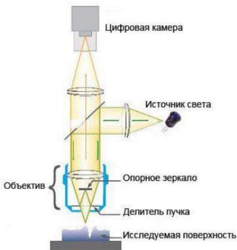
1. Оцените, какую минимальную высоту неровности исследуемой поверхности можно измерить с помощью оптического профилометра с источником монохроматического света ( $\lambda = 370$  нм), если известно, что в процессе анализа смещений интерференционных полос можно различать смещения вплоть до сотых долей периода интерференционной картины.
