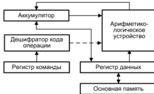
Рисунок 4.2 – Архитектура аккумуляторной машины
