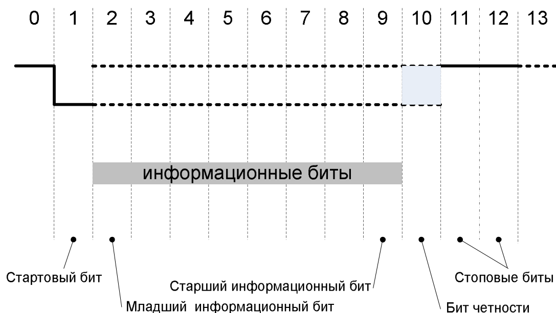
Рисунок 16 - Структура информационной посылки асинхронного последовательного интерфейса (на контактах микро-ЭВМ)
