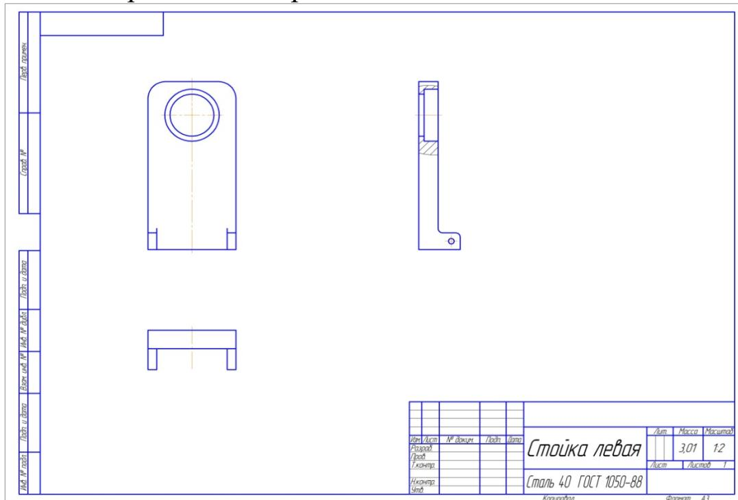
**Задача 3.** На чертеже стойки приставить необходимые размеры с учетом допусков, указать шероховатость поверхности, заполнить технические требования чертежа
