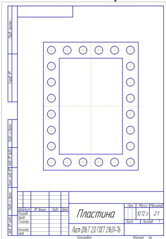
**Задача 8.** На чертеже решетки проставить необходимые размеры с учетом допусков, указать шероховатость поверхностей, заполнить технические требования чертежа.
