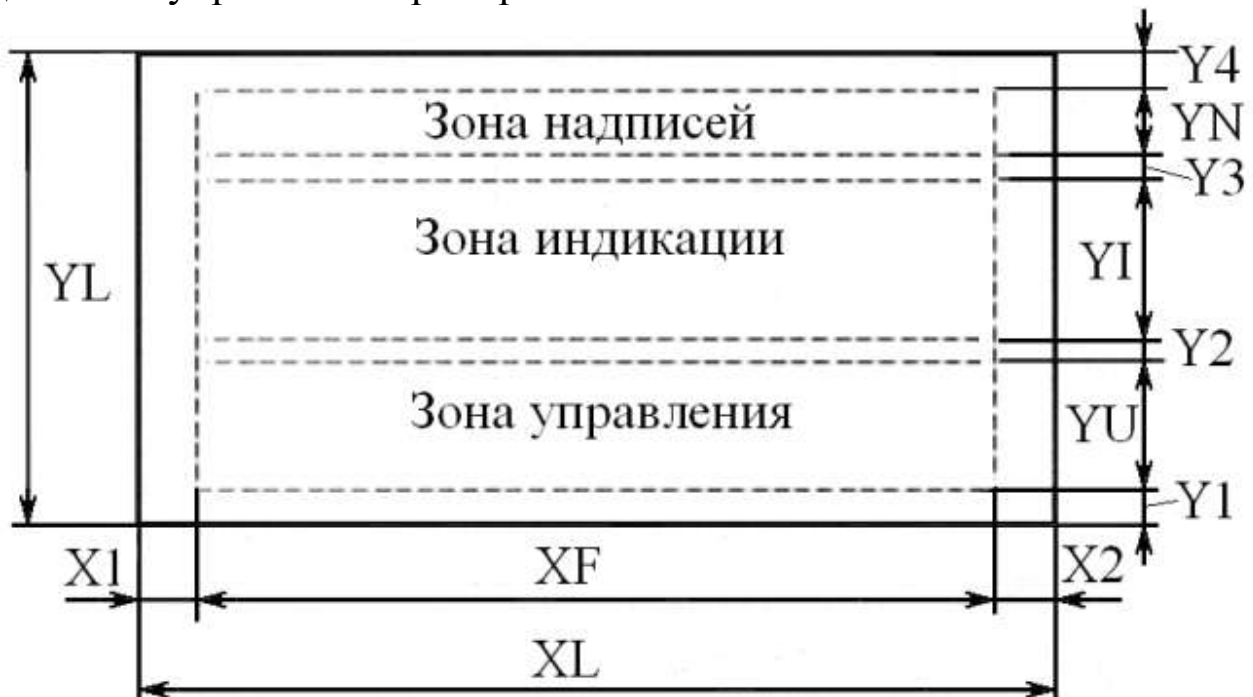
Рис.8.2. - Основное размещение зон на лицевой панели: X_1 , X_2 , Y_1 - Y_4 – краевые поля
