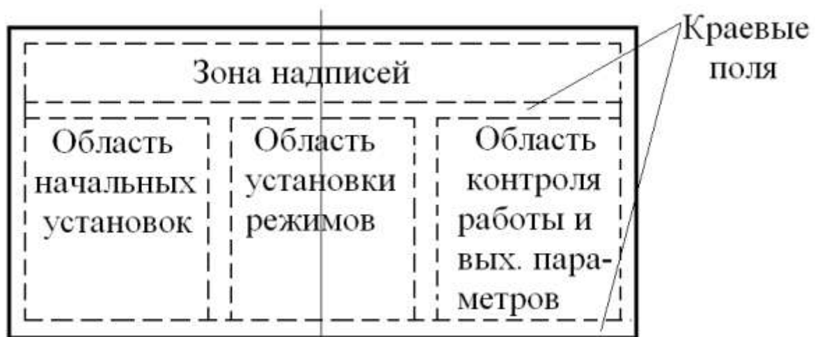
Рис.8.3. Размещение функциональных областей на площади лицевой панели
