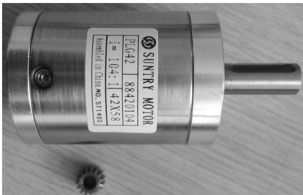
Рисунок 3.3 – Планетарный редуктор Suntry Motor PLG42 с переходной шестерней для двигателя Leshi motor 550PC (на фото редуктор с передаточным числом 104:1)
