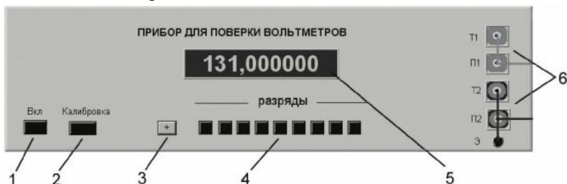
Рисунок 3 – Панель виртуального прибора для поверки вольтметров
