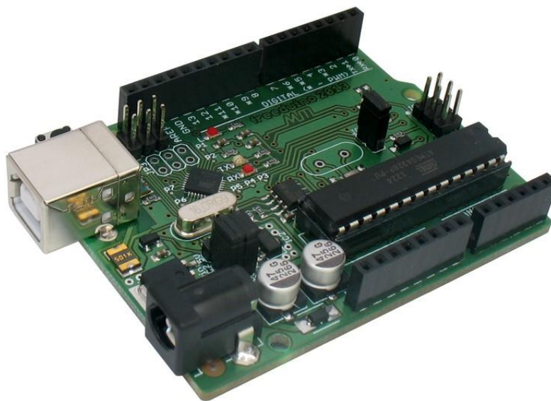
Рисунок 1 - Freeduino 2009 (клон Arduino Duemilanove)
