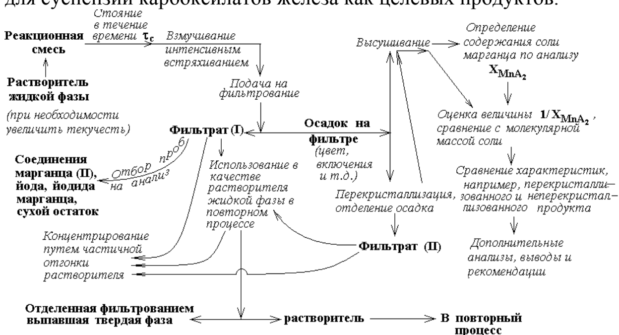
Рисунок 2- Вариант пооперационной схемы разделения реакционной смеси в виде суспензии продукта в жидкой фазе системы
