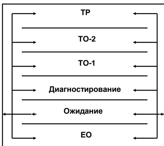
Рисунок 7 – Вариант взаимного расположения производственных зон
