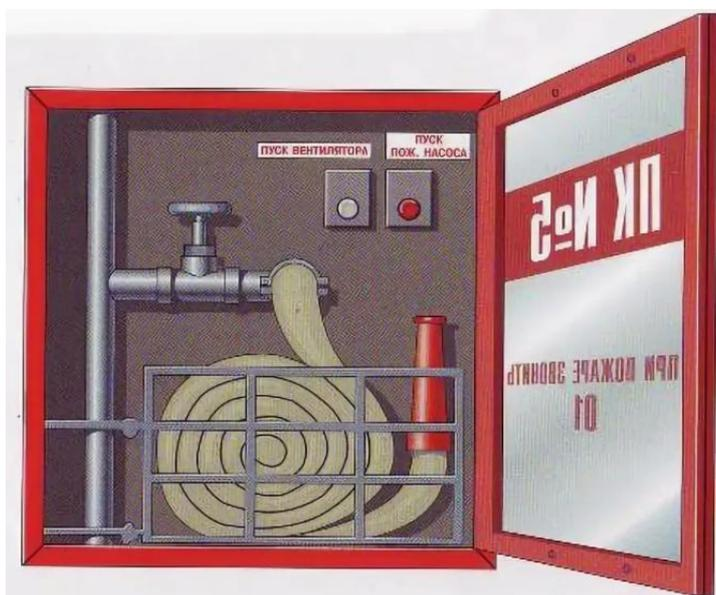
Рисунок 7 Пожарный кран с пожарным рукавом
