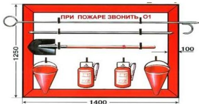
Рисунок 6 - Пожарный щит первичных средств пожаротушения
