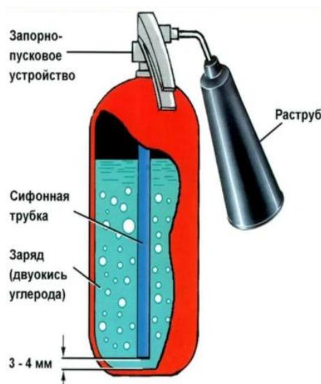
Рисунок 10 – Огнетушитель углекислотный
