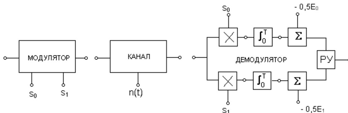
Рис. 20.1. Функциональная схема сменного блока "модулятор - демодулятор"
