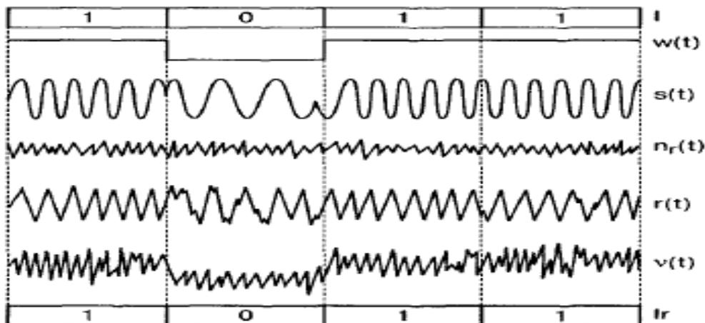
Рис. 2. Временные диаграммы сигналов в радиоканале:
