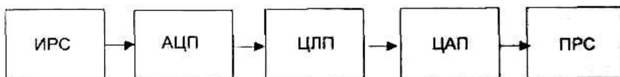
Рис. 3. Типичная схема цифровой линии передачи речевого сигнала: ИРС - источник речевого сигнала; АЦП - аналогово-цифровой преобразователь; ЦЛП - цифровая линия передачи; ЦАП - цифро-аналоговый преобразователь; ПРС - получатель речевого сигнала
