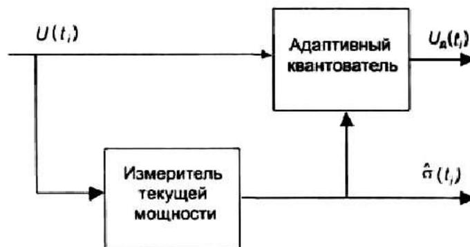
Рис. 5. Адаптивное квантование речевого сигнала
