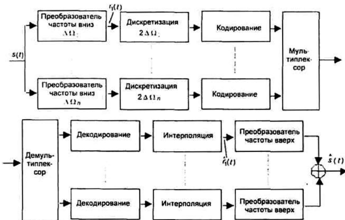
Рис. 7. Функциональная схема многополосного кодека речевого сигнала
