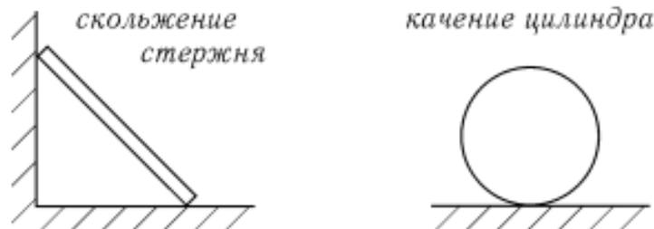
Для задания движения плоской фигуры введем подвижную систему координат  $Ax'y'$ , совершающую поступательное движение с точкой  $A$ . Движение плоской фигуры рассмотрим как сложное, при этом переносное движение — это поступательное движение подвижной системы координат вместе с точкой  $A$  (полюсом). Относительное движение — это вращение вокруг полюса.
