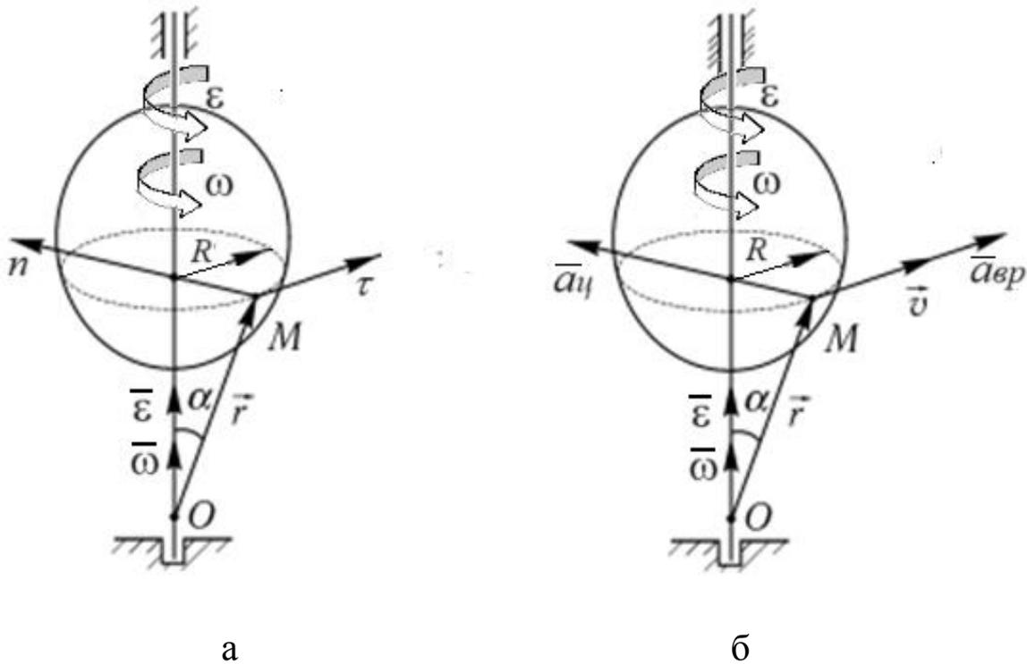
Рис. 1.9. Направление угловой скорости  $\vec{\omega}$  и ускорения  $\vec{\varepsilon}$  при вращательном движении твердого тела: а – ускоренное движение; б – направление скорости и ускорений при ускоренном движении
