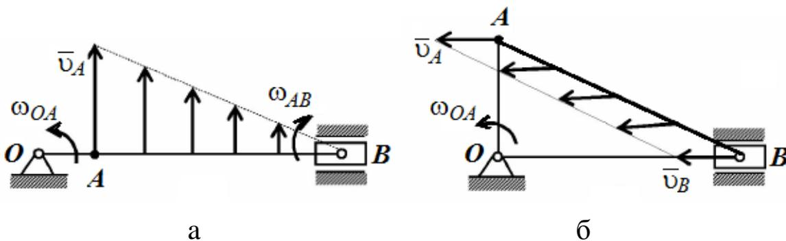
Рис. 2.10. Расчетная схема: а – при  $\varphi = 0$ , б –  $\varphi = 90^0$
