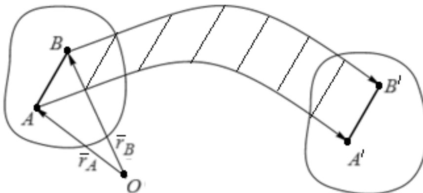
Рис. 1.7. Поступательное движение твердого тела
