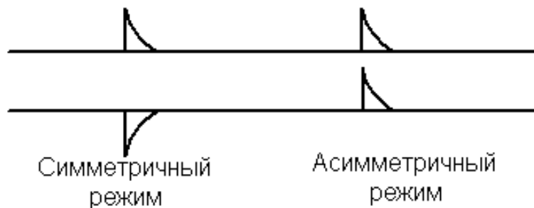
Рисунок 1 – Помехи, образованные симметричным и асимметричным типами токов
