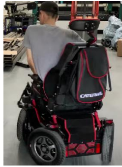
Рис.1.2. Система “крабовый разворот”
