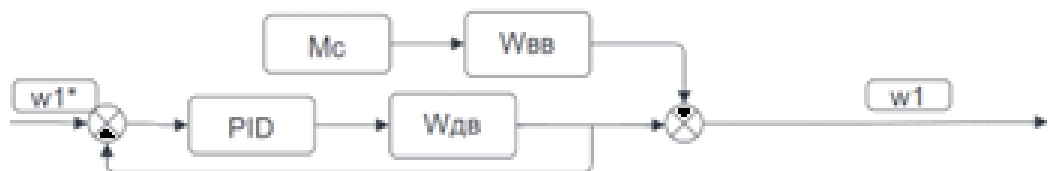
Рисунок.3.1. Структурная схема одноканальной САУ
