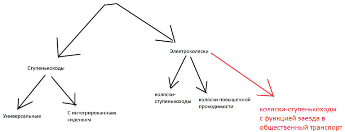
Рисунок.1.1. Схема классификации устройств для преодоления препятствий
