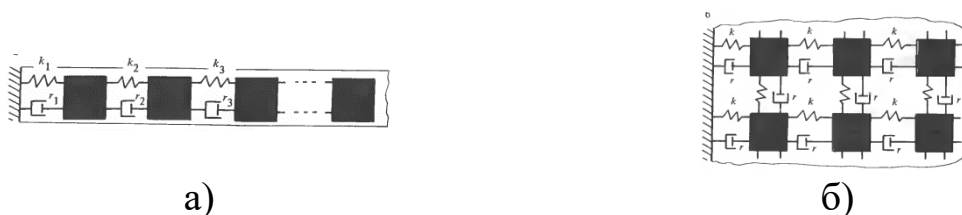
Рис.2.5. Модели конструктивных элементов типа стержней (а) или пластин (б)
