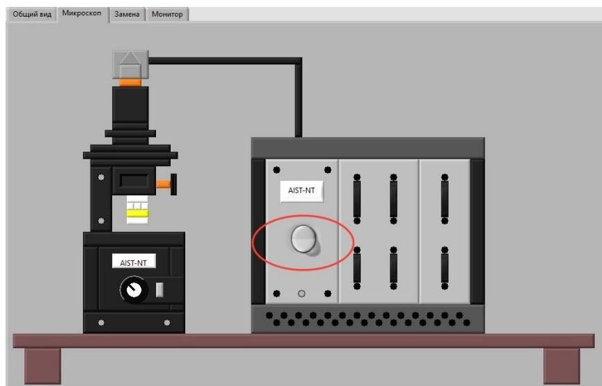
Рисунок 8. – Включение контроллера
