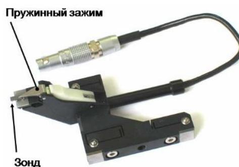
Рисунок 5. – Держатель зонда с зондом
