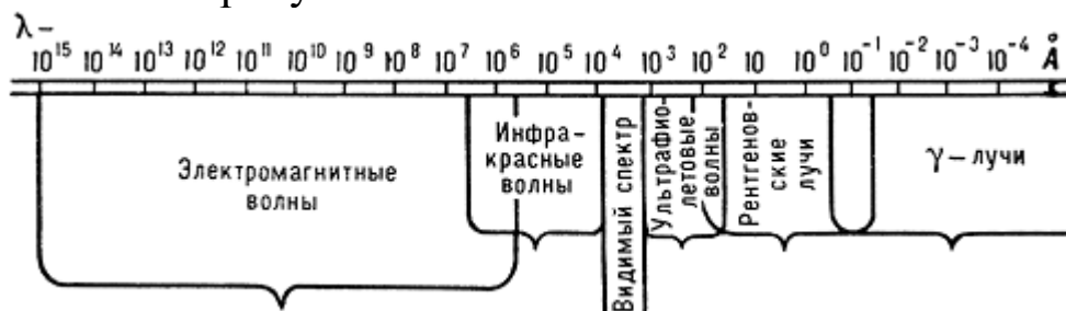
Рисунок 1.1 – Длины волн электромагнитного излучения
