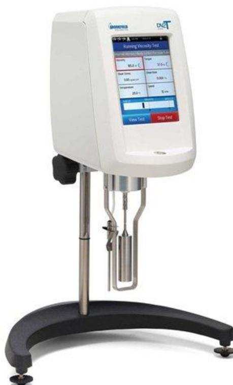
Рисунок 3 – Внешний вид вискозиметра Brookfield DV2T
