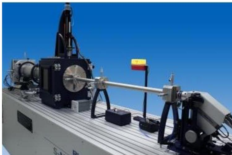
Рисунок 3 – малоугловой дифрактометр Rigaku S-MAX3000
