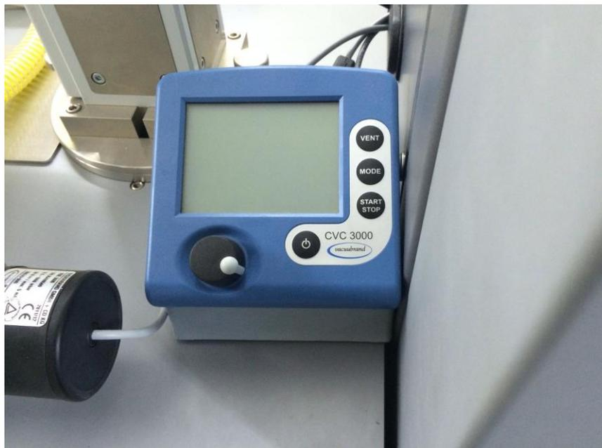
Рисунок 5 – Внешний вид блока управления насосом.
