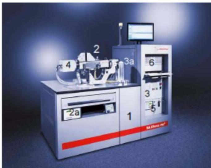
Рисунок 5 – Общий вид установки SAXSess mc<sup>2</sup>: 1 – Основной блок, содержащий устройство питания и насосную систему; 2 – инструментальный блок, включающий в себя экспериментальную камеру и контроль температуры (2а); 3 – генератор рентгеновского излучения с рентгеновской трубкой (3а); 4 – система детектирования или фотопленка; 5 – блок управления системой охлаждения и рентгеновской трубкой; 6 – ПК с программным пакетом
