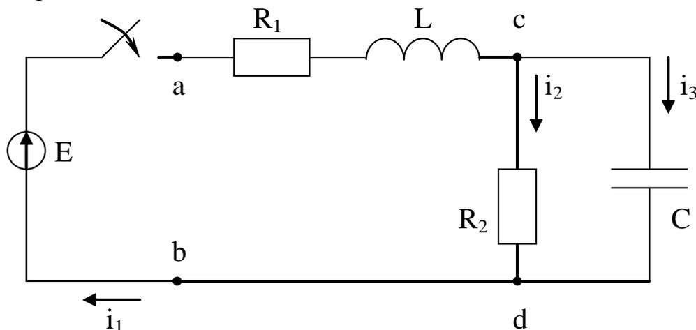
Рис. 3.1. Пример переходного режима в цепи постоянного тока
