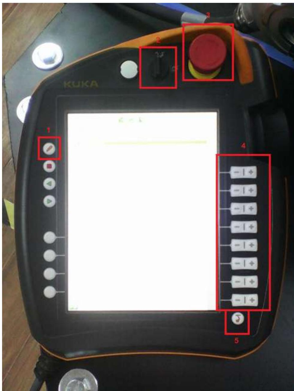
1 - кнопка вызова виртуальной клавиатуры, 2 – поворотный тумблер блокировки/разблокировки SmartPAD, 3 - кнопка экстренной остановки, 4 - кнопки управления поворотом каждой осью (A1-A6), 5 - кнопка вызова меню SmartPAD
