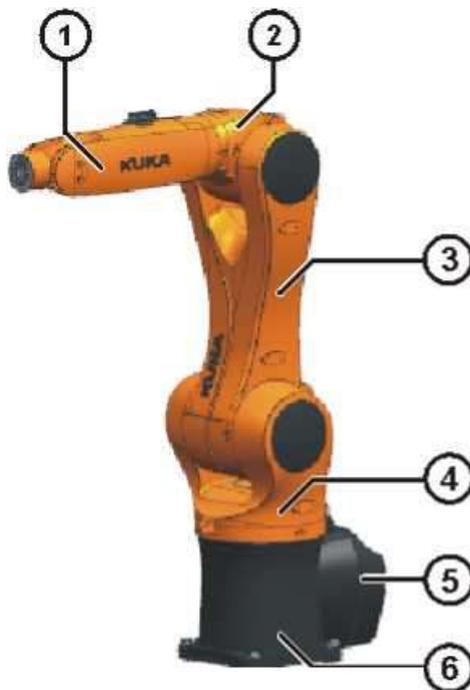
Рис. 2.1 Устройство манипулятора KR AGILUS
