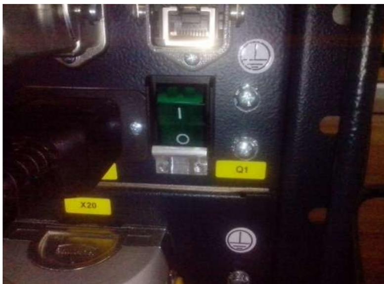
Рис. 5.1 Кнопка включения KR C4
