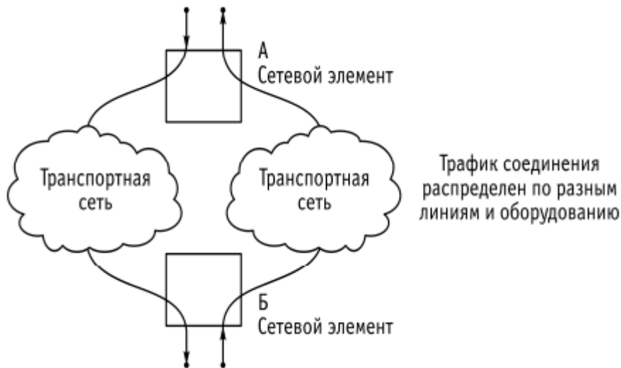
Рисунок 2в – Пример двунаправленного соединения с раздельной передачей
