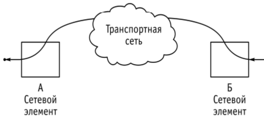
Рисунок 2а – Пример однонаправленного соединения
