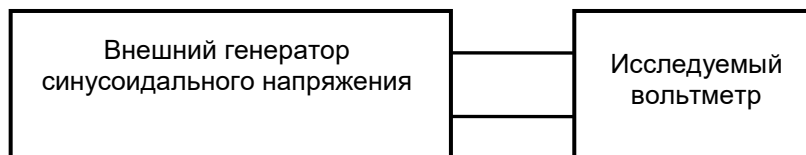
Рисунок 5 – Структурная схема измерения погрешности вольтметра.
