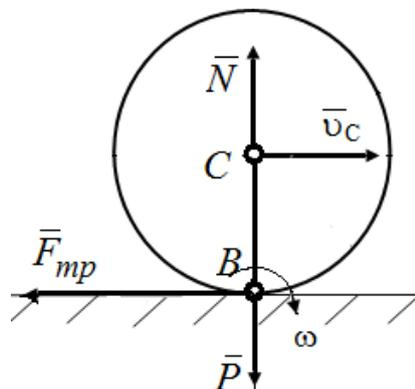
Рис.2.4. Работа сил трения, действующих на катящееся тело
