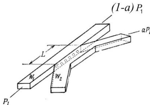
Рисунок 1 – Направленный ответвитель
