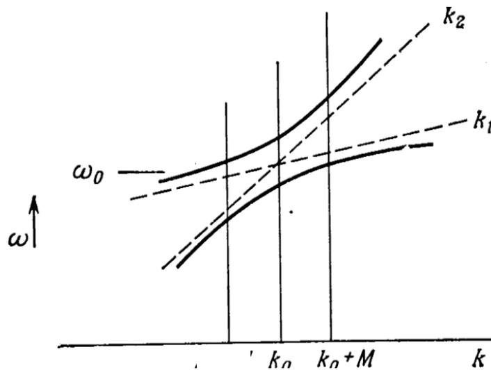
Рисунок 4 – График зависимости  $\omega$  от  $k$  для двух мод в отсутствие связи.
