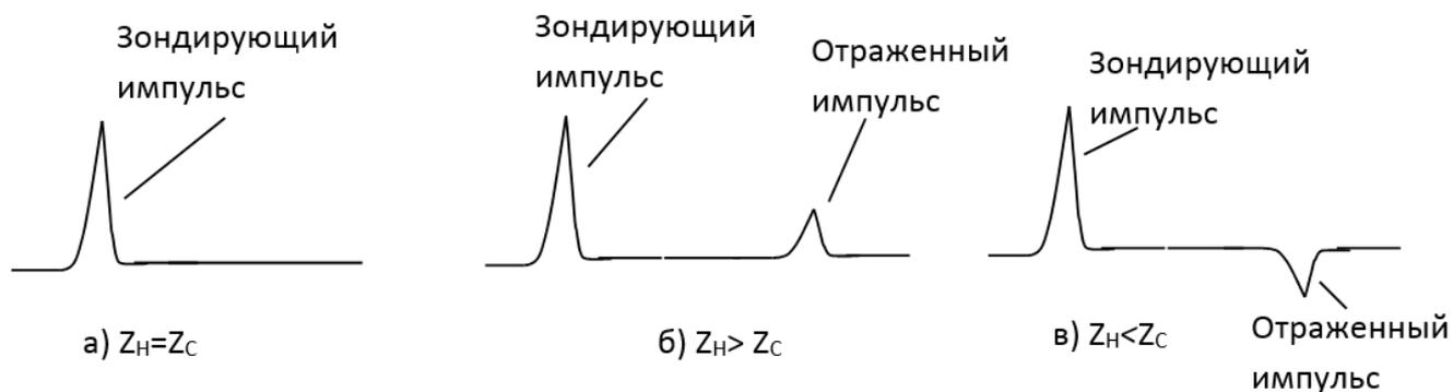
Рисунок 1 – Возможные положения зондирующего и отраженного импульсов
