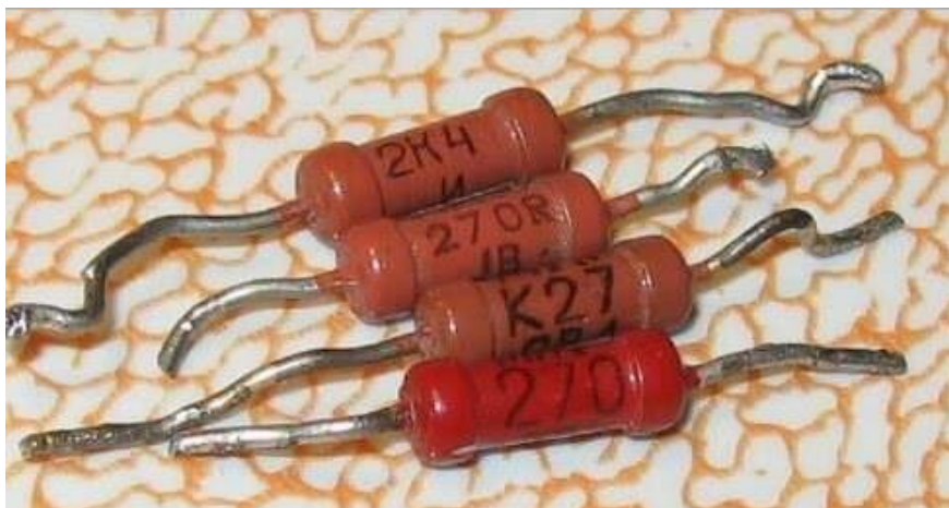
Рисунок 1.1. Резистор МЛТ советского производства с буквенно-цифровой маркировкой.
