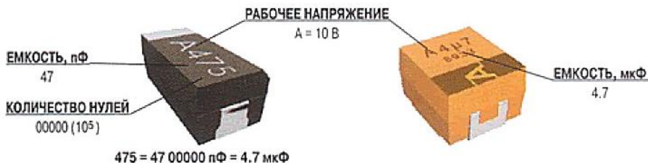
Рисунок 1.11 – Маркировка SMD
