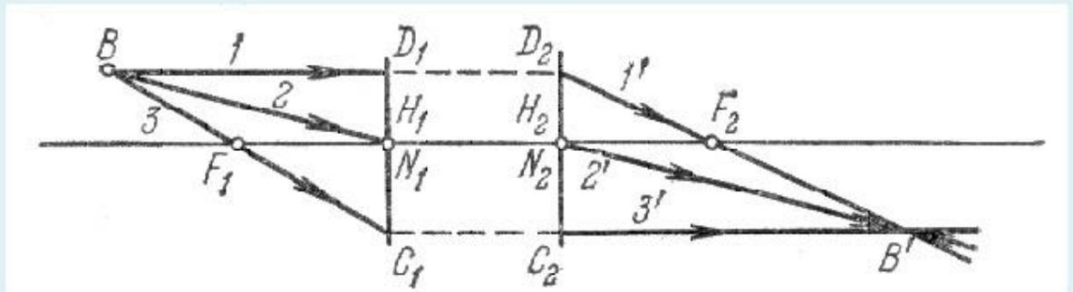
На рис. проведены лучи, построение которых особенно просто определяет положение точки  $B'$ , сопряженной с точкой  $B$ . В силу гомоцентричности пучка любой другой луч из  $B$  пройдет через  $B'$ .
