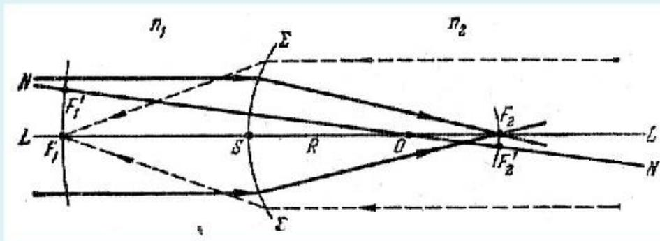
Геометрическое место точек  $F_1 F_1' \dots$  образует сферическую поверхность с радиусом  $|R - f_1|$  (на рис.  $f_1 < 0$ ), concentricкую с преломляющей сферой (с центром в точке  $O$ ). Эта поверхность носит название *передней фокальной поверхности*.
