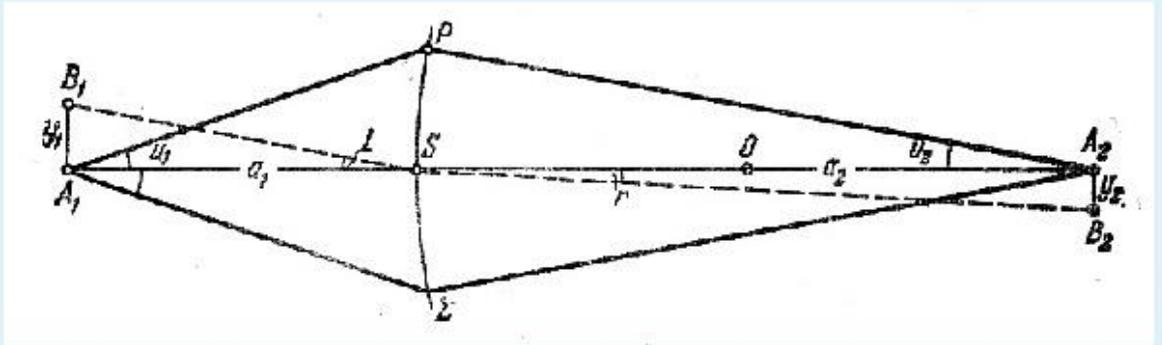
Отношение линейных размеров изображения ( $y_2 = A_2B_2$ ) и предмета ( $y_1 = A_1B_1$ ) носит название *линейного* или *поперечного* увеличения  $V = y_1/y_2$ . Увеличение положительно -
