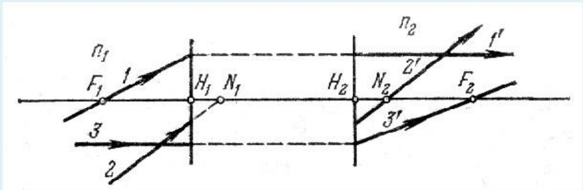
Плоскости, проходящие через узлы перпендикулярно к оптической оси, называются *узловыми плоскостями*. Шесть плоскостей (две фокальные, две главные и две узловые) и шесть точек главной оси, им соответствующие (фокусы, главные точки, узлы), называются *кардинальными плоскостями и точками*
