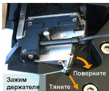
Рисунок 8 Держатель зонда, зафиксированный зажимом
