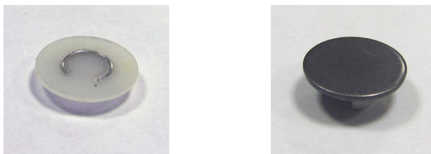
Рисунок 7 Держатели образца: 1 – базовый держатель, 2– магнитный держатель
