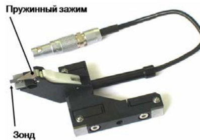
Рисунок 3 Держатель зонда с зондом
