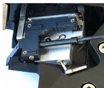
Рисунок 11 Держатель зонда в незафиксированном положении
