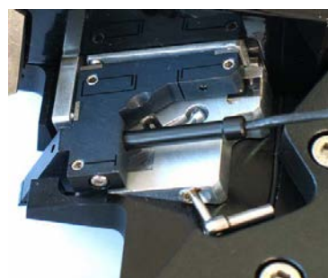
Рисунок 9 Держатель зонда в незафиксированном положении
