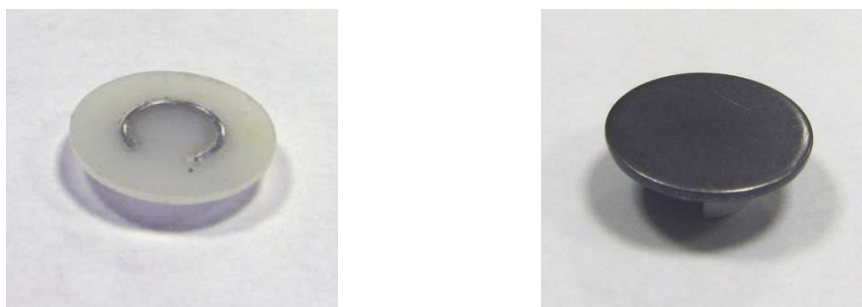
Рисунок 5 Держатели образца: 1 – базовый держатель, 2– магнитный держатель
