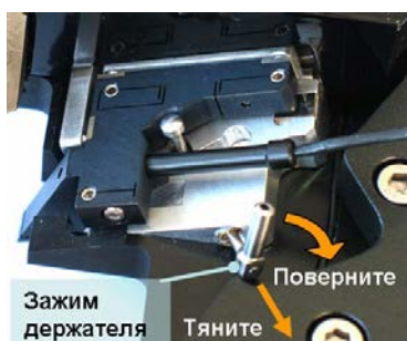
Рисунок 10 Держатель зонда, зафиксированный зажимом
