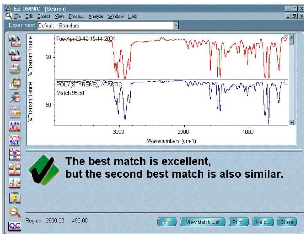
Рисунок 9 Сравнение измеренного спектра с библиотечными
