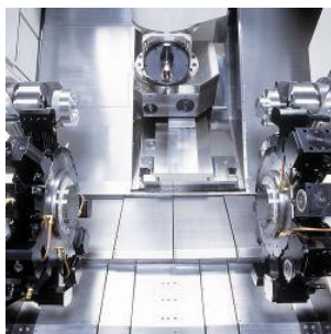
Рисунок 4.1 - Токарно-фрезерный центр Nakamura-Tome
