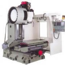
Рисунок 3.5 - Установка магазина на шпиндельной бабке станка
