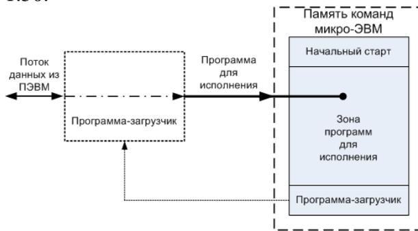
Рисунок иллюстрирует процесс загрузки программного кода для платформы Arduino:
