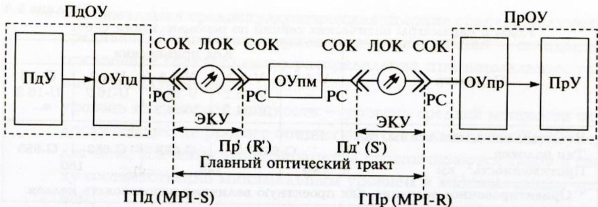
Рис. 4. Опорные точки нормирования стыков СЦИ с оптическими усилителями:  $ГП_d(MPI-S)$ ,  $ГП_r(MPI-R)$ ,  $P_d'(S')$ ,  $P_r'(R')$
