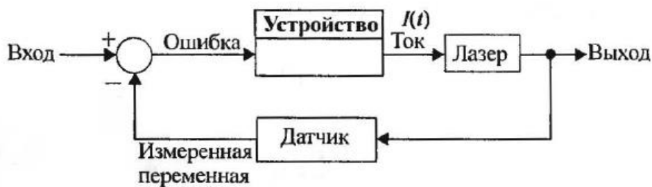
Рис. 2. Функциональная схема (частично) источника оптического излучения
