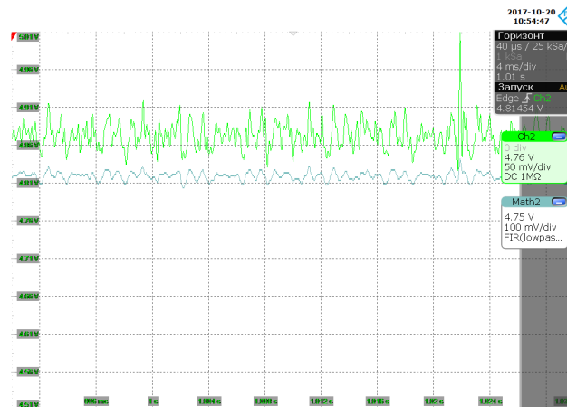
Рисунок 5.5 – Совмещенные осциллограммы сигнала и отфильтрованного сигнала с фоторезистора
