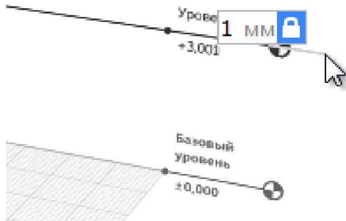
Расположение плоскости сечения и плоскости глубины видимости, заданные параметрами уровня, определяют область видимости, в которой отображаются объекты на виде уровня. Если плоскость сечения пересекает объект, то на виде отображается его сечение. Если плоскость сечения не пересекает объект, который находится в области видимости, то на виде отображается его проекция.
